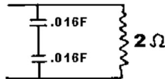
**12.- ¿Cuál es el ángulo de desfase de la corriente con respecto al voltaje del siguiente circuito? Suponga un voltaje de entrada de 120 V, 10 Hz:**
