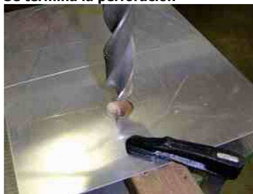
Se termina la perforación
